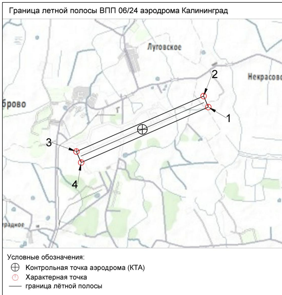
Рисунок 4.2. Схема границ летной полосы
